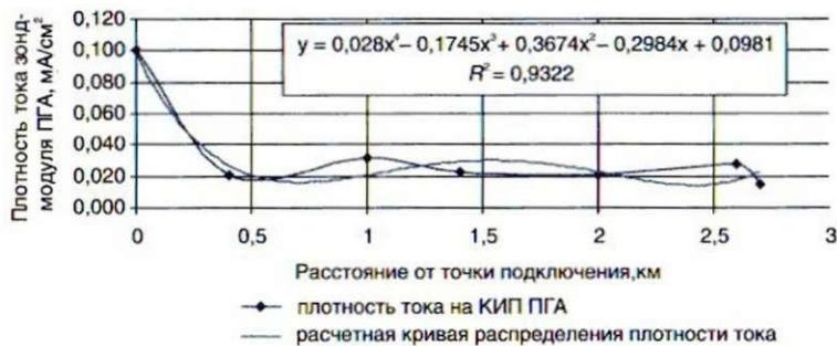
Рис. 6. График распределения плотности тока по длине ПГА при одностороннем подключении
