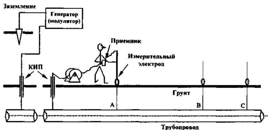
Рис. 3 Схема подключения генератора (модулятора) и измерения сигналов переменных напряжений по длине трубопровода приемным устройством, например, типа УДИП-1м
