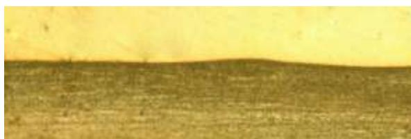
а) Линия проплавления паяного соединения в продольном направлении после травления 4% спиртовым раствором азотной кислоты
