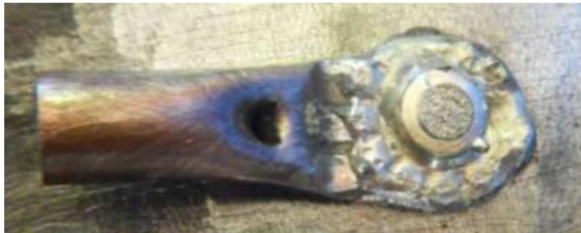
Рис. 5. Внешний вид паянного соединения.
