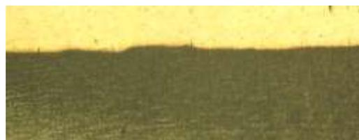
б) Линия проплавления паяного соединения в поперечном направлении после травления 4% спиртовым раствором азотной кислоты
