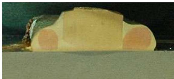
б) Макроструктура паяного соединения (поперечный шлиф)
