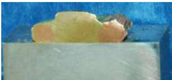
а) Макроструктура паяного соединения (продольный шлиф)
