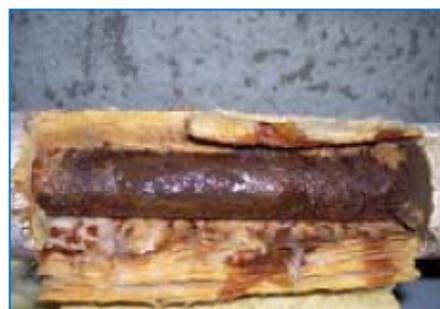
Сильная коррозия наружной стенки трубы, вызванная коррозией под слоем изоляции
