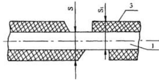
Рис.3.4. Определение разности толщины покрытия  $e$ :  $e = S - S_1$
