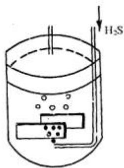
Рис.3. Испытания образцов на коррозионную стойкость по NACE TM-02-84
