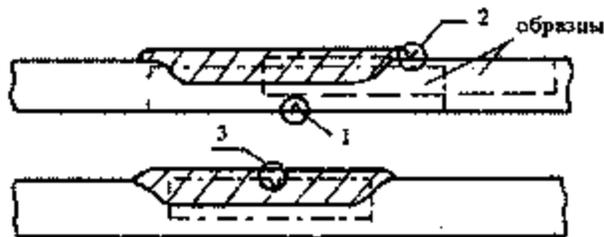
б) образцы для испытаний на ударную вязкость: основного металла 1, зоны впадения 2 и наплавленного металла 3
