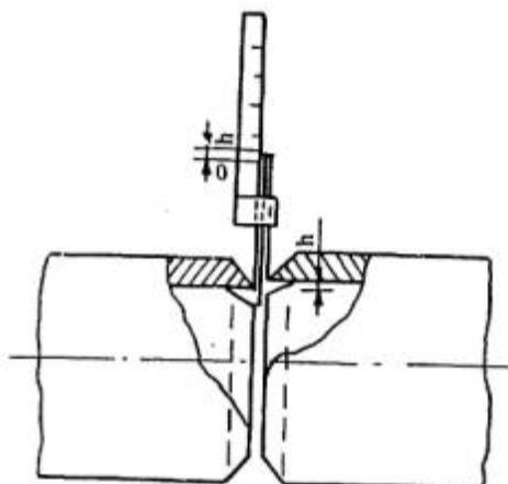
Рис.2.1. Схема замеров внутреннего смещения кромок
