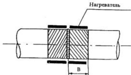
Рис.2.3. Схема нагрева труб перед сваркой: В - ширина зоны нагрева
