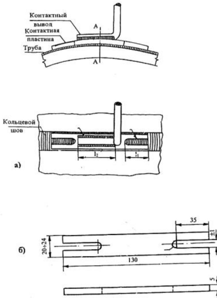
Рис.1.12. Схема приварки контактного выхода ЭХЗ к кольцевому шву (а) через переходную пластину (б):
