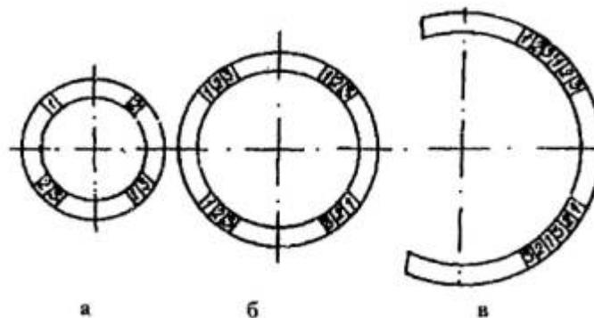
Рис.1. Схема отбора образцов для механических испытаний сварных соединений труб диаметром:
