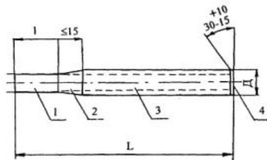
Рис.3.3. Сварочный электрод:
