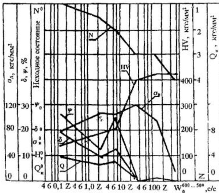
Рис.3.1. Примерный график зависимости временного сопротивления ( $G_B$ ), относительного удлинения после разрыва ( $\delta$ ), относительного сужения после разрыва ( $\psi$ ), твердости ( $H_V$ ), ударной вязкости ( $a_n$ ) и балла зерна ( $N$ ) от скорости охлаждения для стали 35 (по данным [ГОСТ 23870-79](#))
