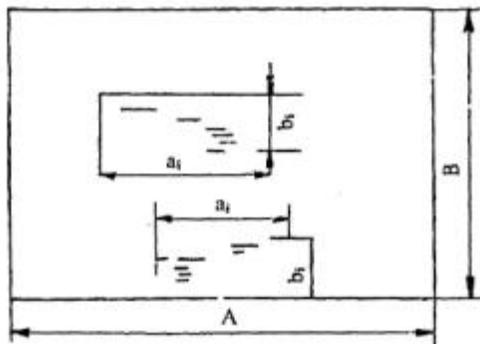
Рис.4. Расположение трещин при определении CLR, CTR
