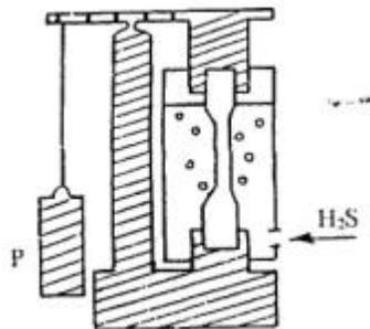
Рис.1. Испытания образцов на коррозионную стойкость по NACE TM-01-77 (МСКР-01-85)
