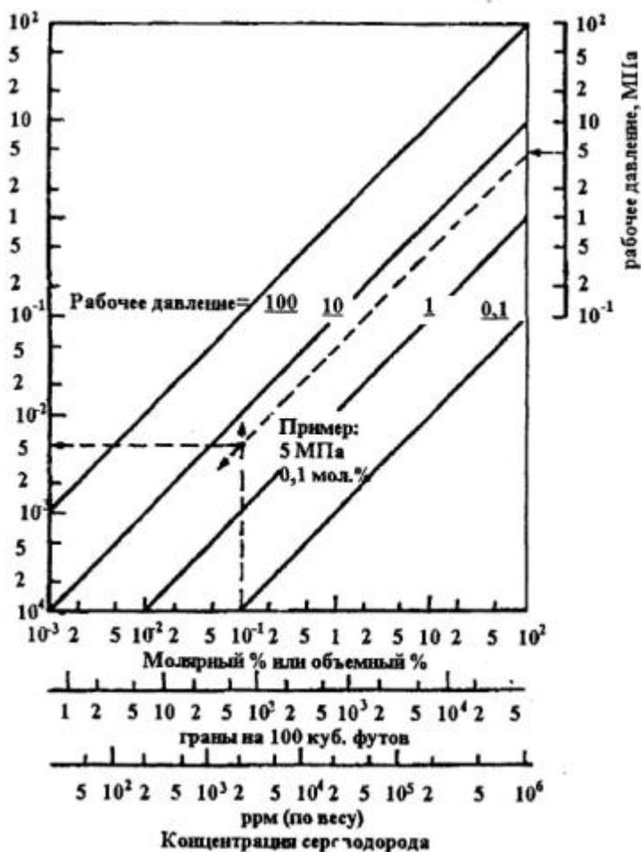
Рис.5. Зависимость парциального давления сероводорода от его концентрации при различных рабочих давлениях газа в трубопроводе ([ВСН 006-89](#))
