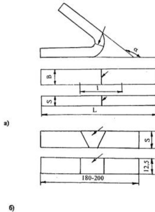
Рис.3. Эскизы образцов для механических испытаний сварных соединений на изгиб по [ГОСТ 6996-66](http://www.gost.ru); а - корнем шва наружу или внутрь; б - на ребро; 1 - длина рабочей части образца, равная  $0,33L$
