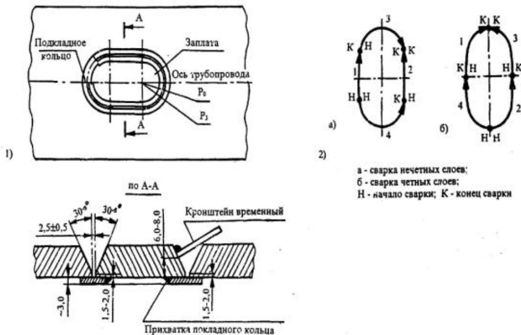
Рис. 1.6. Схема заварки технологической заплаты: 1 - форма обработки; 2 - последовательность выполнения слоев шва;  $P_0$  - радиус окна;  $P_1$  - радиус заплаты
