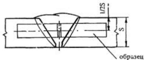
Рис.4. Схема расположения образцов
