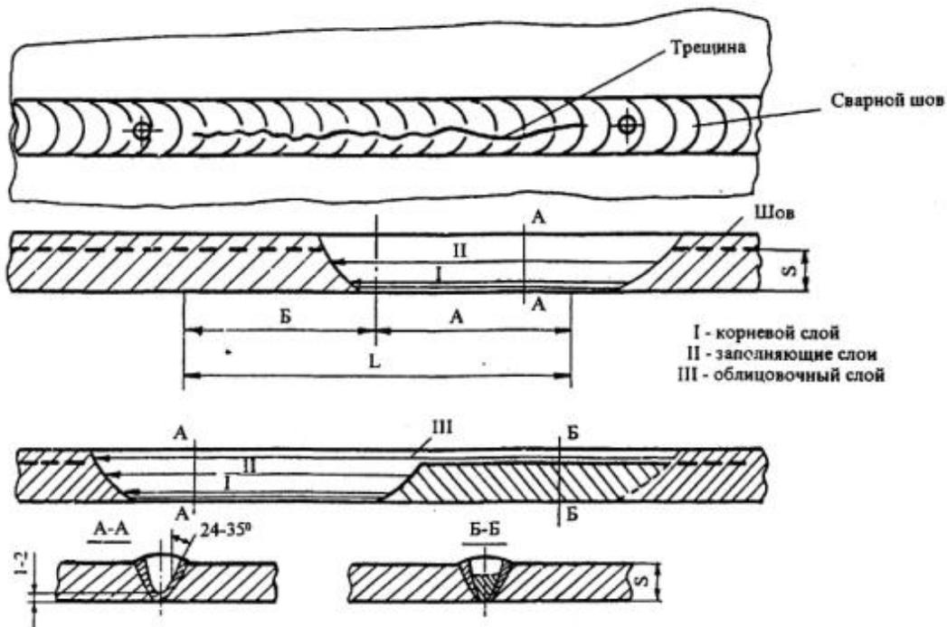
Рис. 1.4. Схема заварки участка стыка (выборки) при длине трещины от 100 до 250 мм:
