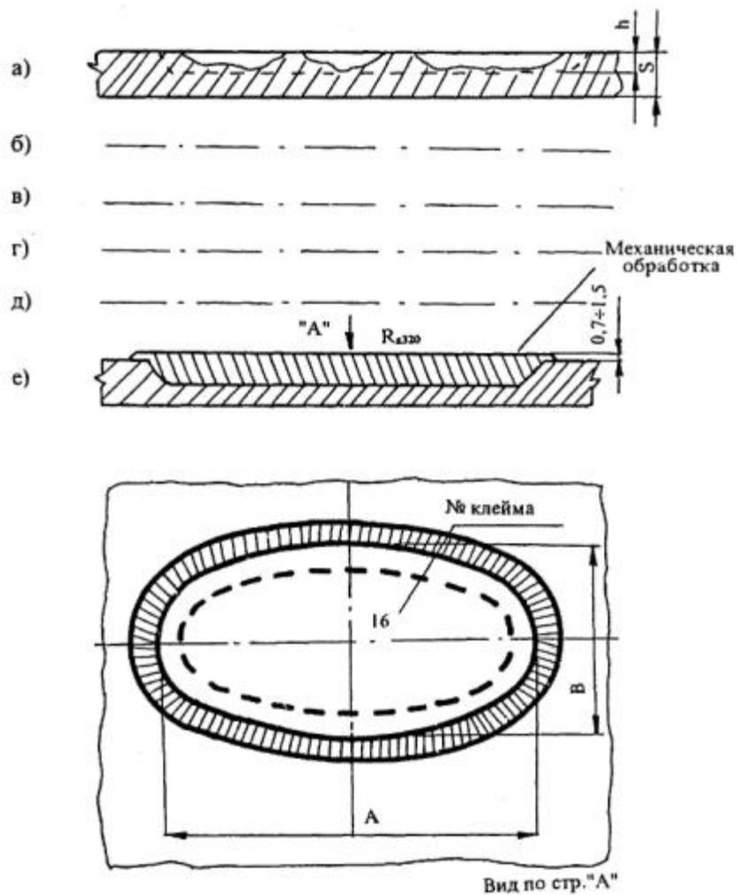
Рис.1.3. Схема заварки каверн с эллипсной обработкой поврежденного участка: виды а, б, в, г, д, е - аналогичны [рис.1.2](#).
