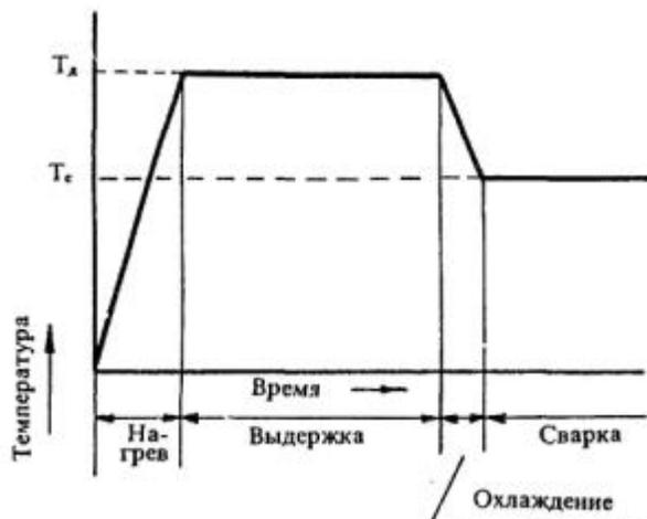
Рис. 2.4. Цикл предварительного подогрева труб:
