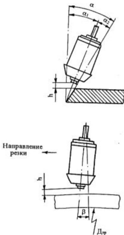
Рис.1.7. Схема установки плазматрона при механизированной резке:
